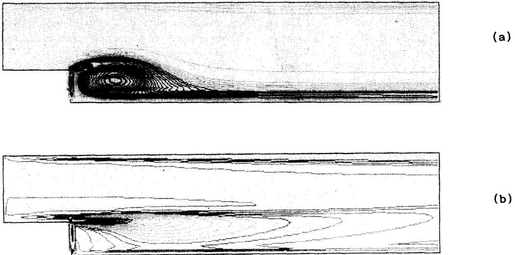
FIG. 6. Calcul isotherme : (a) recirculation moyenne relative à la simulation numérique ; (b) recirculation calculée par le modèle  $k-\epsilon$  ;  $R = 0.5$  ;  $Re_h = 90\,000$  ;  $X_s = 16h$  ;  $X_e = 2.0h$ .
